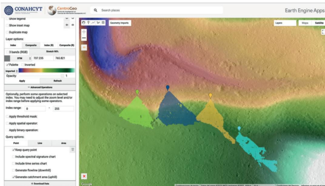
Con el objetivo de priorizar sitios puntuales de búsqueda en la Barranca de la Carnicería, se elaboraron modelos para simular las líneas de máximo descenso y determinar los puntos de mayor acumulación de sedimentos.
